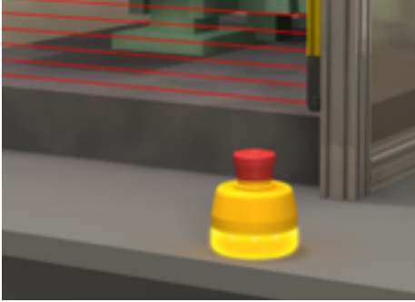
Paradas de emergencia
